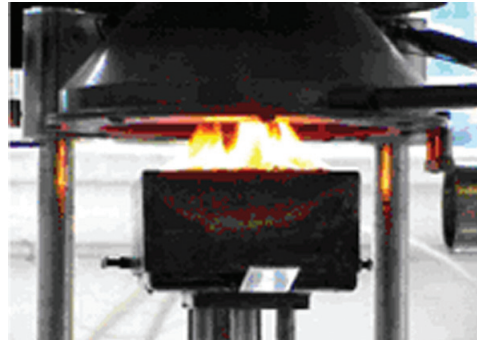
Şekil 13: Konik kaloriölçer metodu ile bitümlü karışım numunesinin kızdırılması
