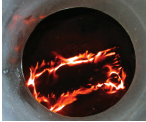
Şekil 8: Yanma esnasında bitümlü karışım (Cergy – Pontoise Üniversitesi)
