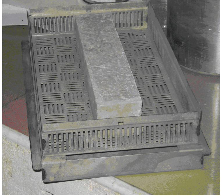
Şekil 15: Kür odasında bekletildikten sonra, fırında 350°C ve 450°C arasındaki sıcaklıklara maruz kalan numuneler
