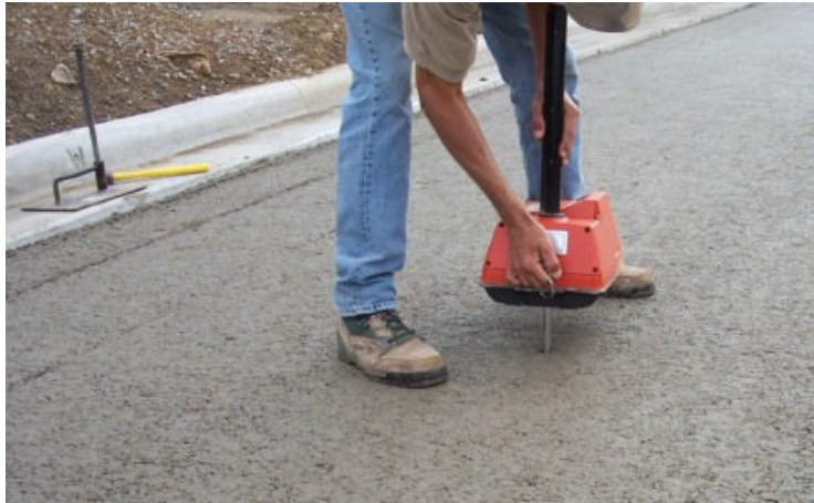
Şekil 6: Yoğunluk ölçümünde nükleer cihazların kullanımı [10]
