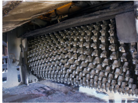
İnce kazıma makinesinin kazıyıcı başlıklarının detayı Fotoğraflar: Wirtgen
