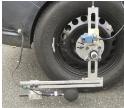
Kapalı yakınlık metodu ile tekerlek-yüzey etkileşiminden kaynaklanan gürültünün ölçümü (Solda)
