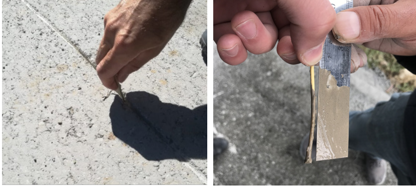
Şekil 6. Derz derinlik kontrolü
