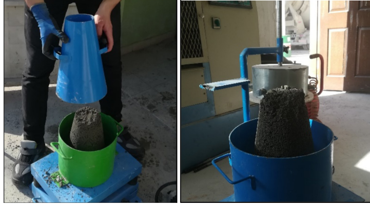
Şekil 6. VeBe Kıvam Testi
