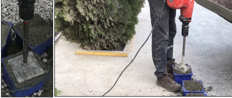
Şekil 4. SSB Küp Numunelerin Hazırlanması
