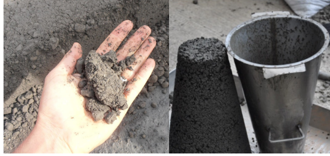
Şekil 2. Silindirle Sıkıştırılmış Beton
