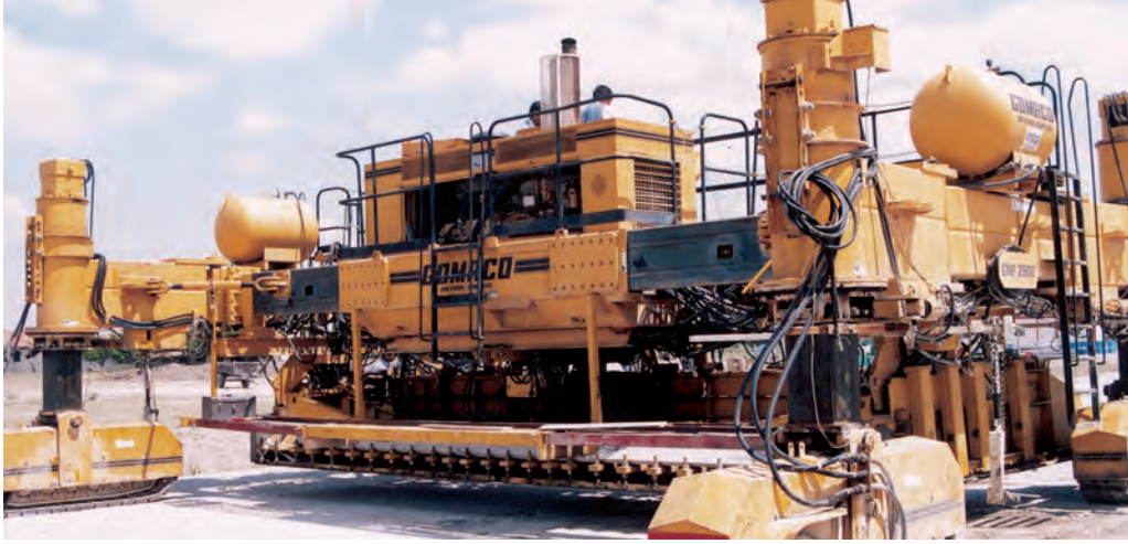
Şekil 18. Kayar kalıp finişer (arkadan görünüş)
