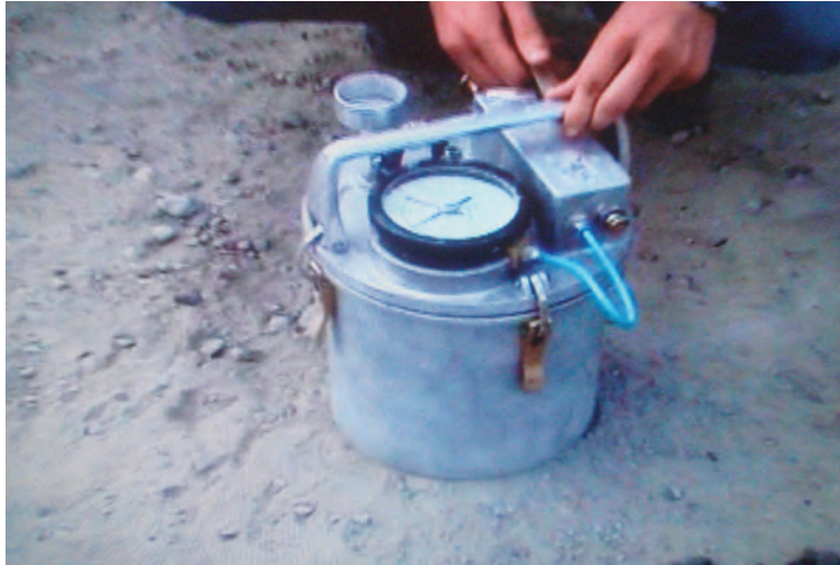
Şekil 65 Betonda hava miktarının ölçümü
