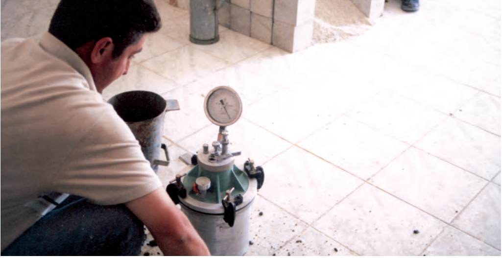
Şekil 8. Taze betonda hava miktarının ölçümü
