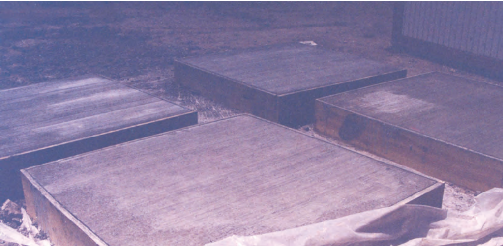
Şekil 9. Betonda büzülme ve çatlama kontrol numuneleri
