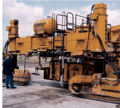
Şekil 23. Finişer başlangıç yerine getiriliyor
