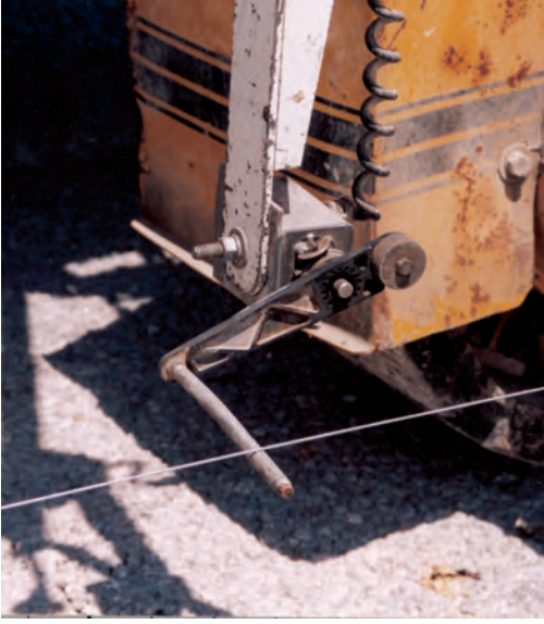
Şekil 24. FİNİŞER KILAVUZ TELİ İLE İRTİBATLANDIRILIYOR
