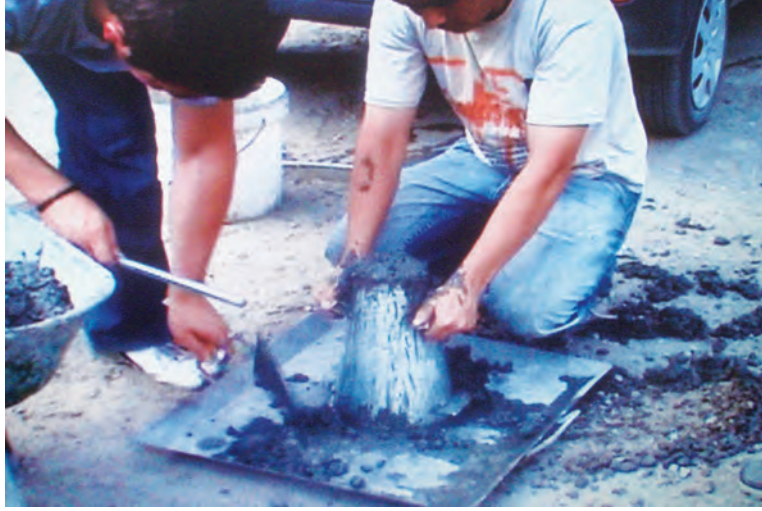
Şekil 66 Betonda çökme deneyi
