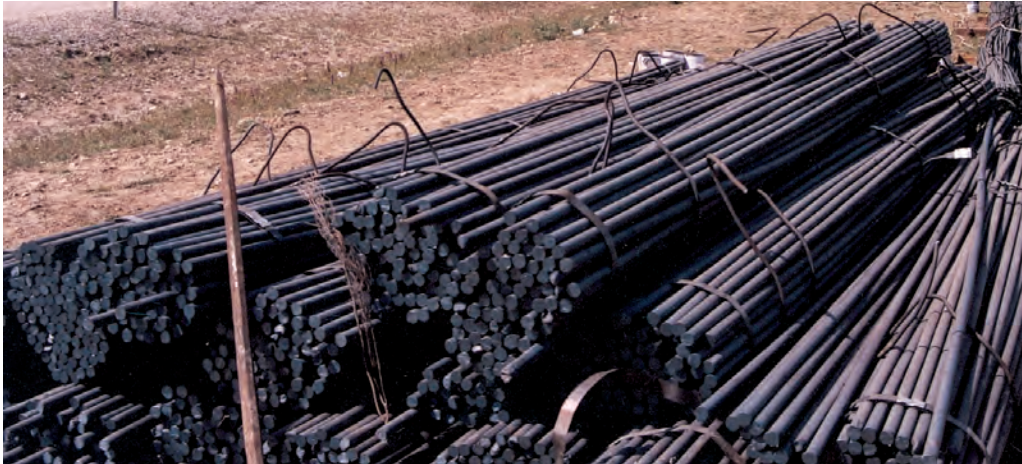
Şekil 10 . Kayma demirleri ( \varnothing 28 mm)
