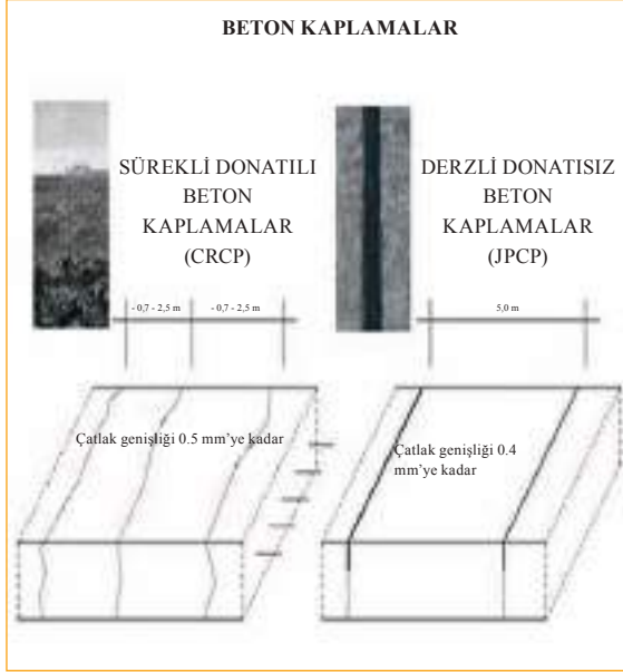
ŞEKİL 1 – BETON KAPLAMALAR, YAPIM TİPLERİ
